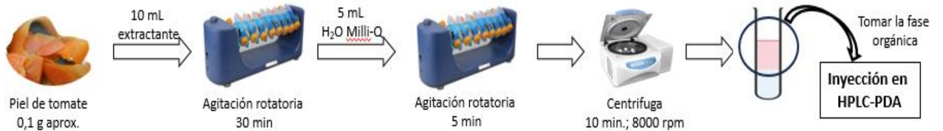
Esquema 1. Procedimiento de extracción de licopeno de piel de tomate con disolvente orgánico.
